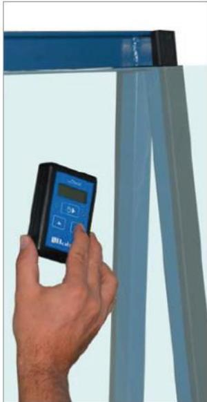
В современном стекольном производстве используется преимущественно технология получения стекла на расплаве металлов. Данный производственный процесс обуславливает различия стороны стекла, имевшей контакт с расплавленным оловом, и стороны, обращённой к атмосфере. При разных видах обработки стекла необходимо знать, какая сторона стекла имела контакт с расплавом олова во время производственного процесса.
